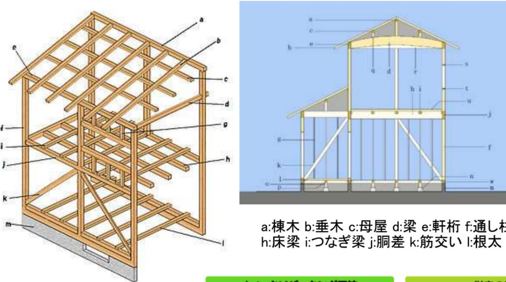
a:棟木 b:垂木 c:母屋 d:梁 e:軒桁 f:通し柱 g:間柱
